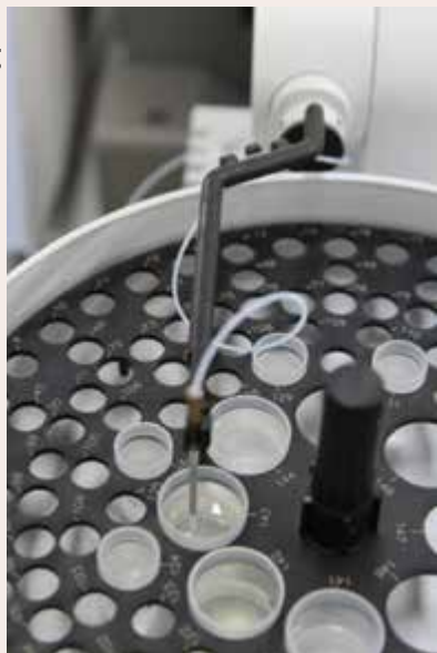
Tubo coletor aspirando amostra no novo espectrofotômetro de absorção atômica com forno de grafite
